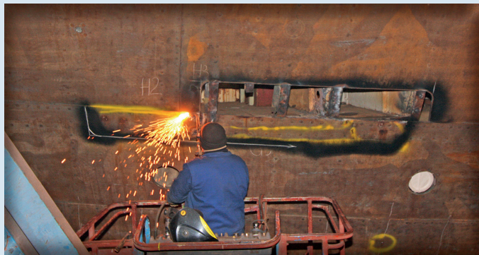
▼ Uitbranden van een slechte huidplaat, boeg bakboord (22 januari 2016).
