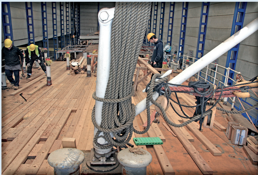
▼ Het voordek of plecht klaar voor de plaatsing van de dekbeplanking. (10 maart 2016).
