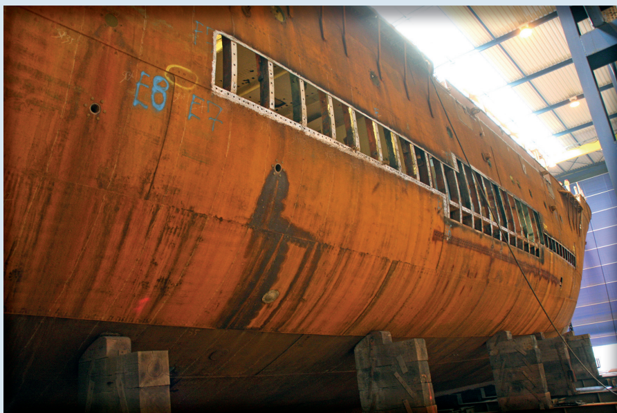
▼ De slechte huidplaten zijn verwijderd van de romp. (6 april 2016).
