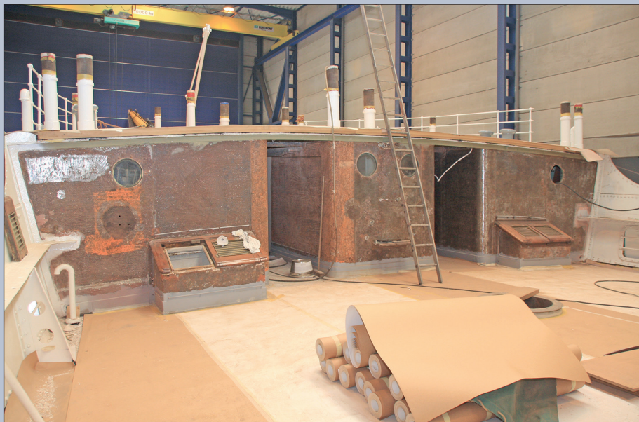
De voorkant bakdek is volledig "gestript" en klaar om te schilderen. (18 januari 2017)
