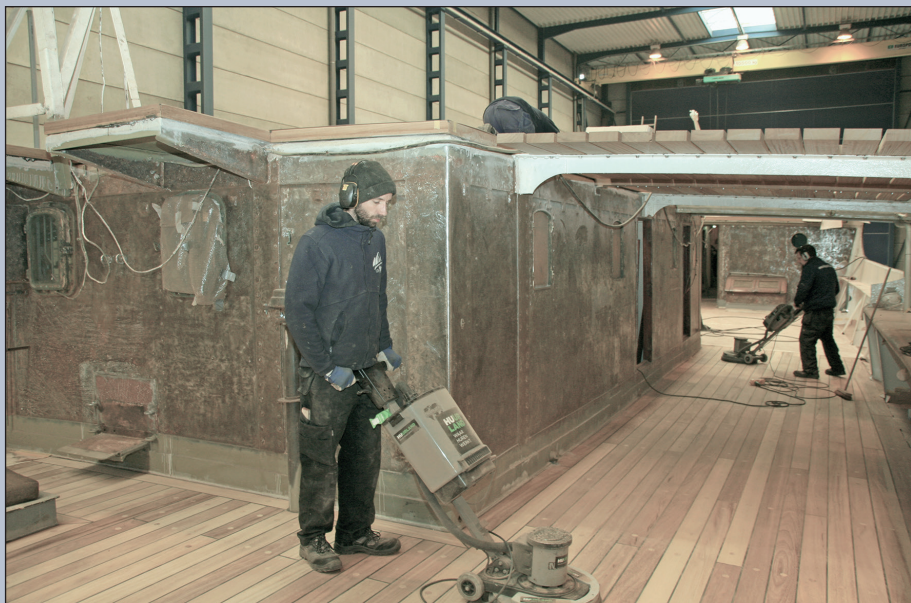
Het finaal opschuren van de dekplanken op het hoofddek aan stuurboord. (18 januari 2017)
