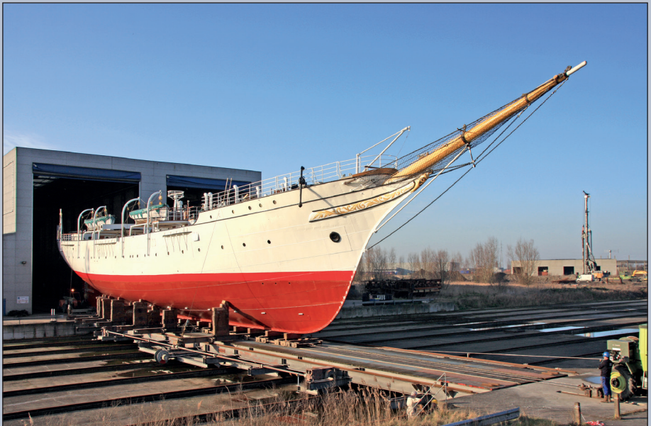
De Mercator staat met de kielwagen op de railwagen en zal richting scheepslift getrokken worden. (14 februari 2017)
