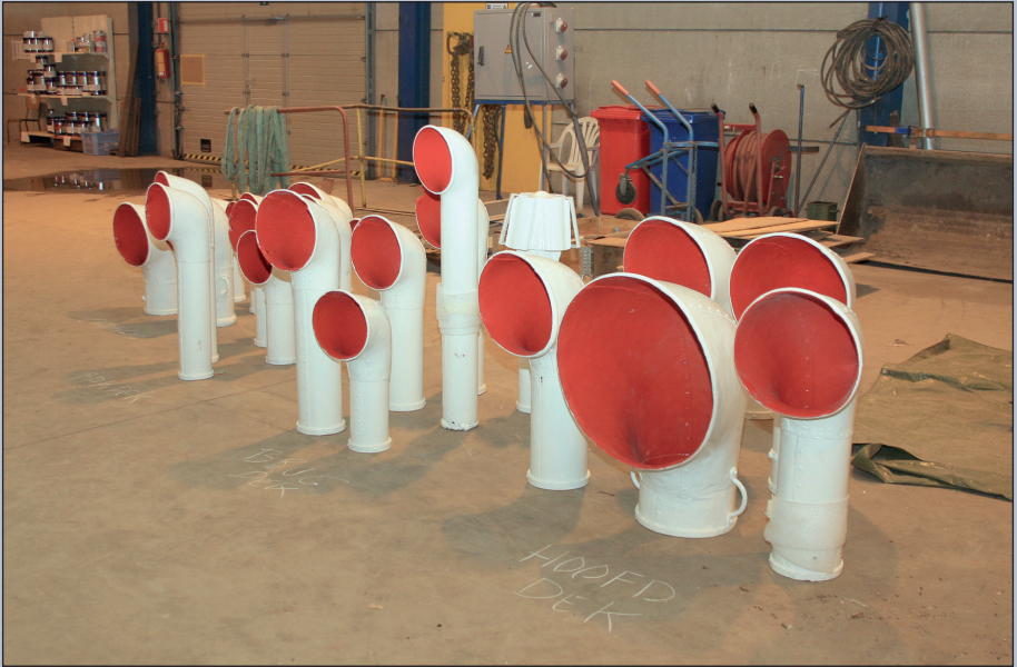
De geverfde luchthappers klaar voor plaatsing. (18 januari 2017)
