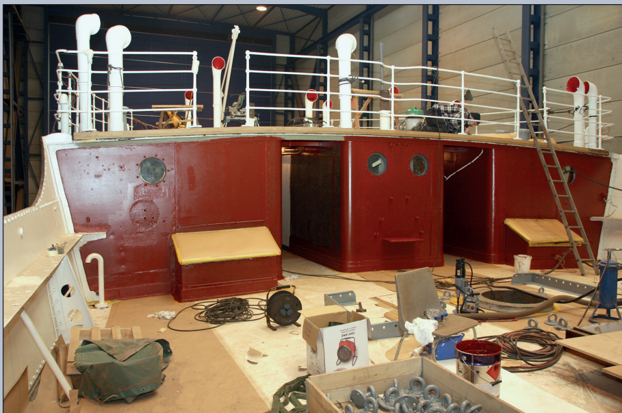
De voorkant bakdek in zijn eerste grondlaag. (24 januari 2017)
