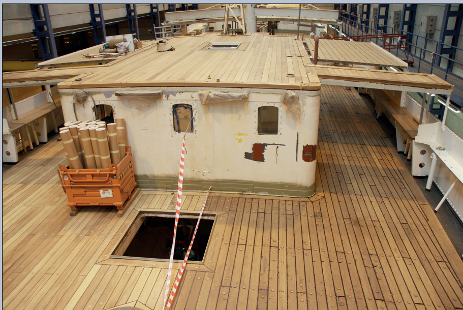
De dekplanken aan stuurboordzijde hoofddek zijn effen geschuurd, aan bakboord zal begin januari begonnen worden. (6 januari 2017)
