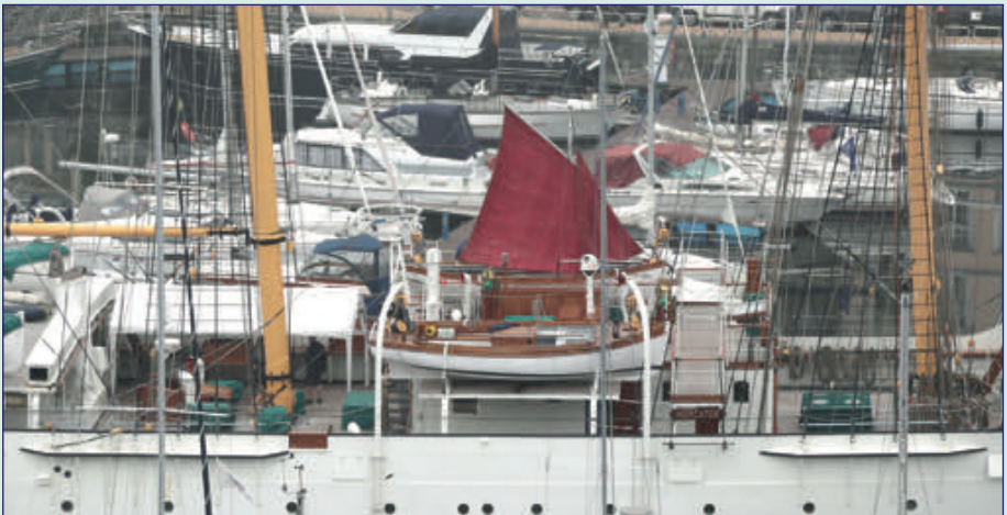
Roodbruine zeiltjes van de reddingsboten, dit om bij eventueel gebruik beter op te vallen tussen de witschuimende golven.
